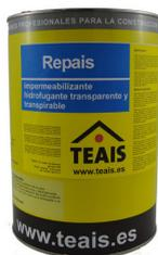
**Repais** es una resina a base de siloxanos oligómeros de baja molecularidad, que facilita su penetración en el interior del soporte sin dejar residuo ni brillo en la superficie, logrando su hidrofugación, sin inhibir la transpiración del material ni permitir la disolución de sales solubles, actuando como hidrofugante integral.
