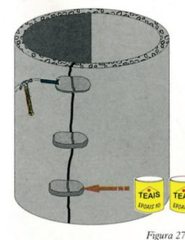
En el caso de depósitos cilíndricos, la reparación de grietas es similar al caso de depósitos rectangulares. Se practican los agujeros para alojar el GRAPAIS 300, se incorpora EPOAIS 10 para realizar uniones perfectas.
