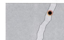
Cuando estén colocadas todas las boquillas emplastecemos toda la grieta con EPOAIS H, para evitar las fugas de la resina epoxi. Una vez que esté seco el emplaste comenzaremos a inyectar EPOAIS INY por las boquillas ya colocadas.
