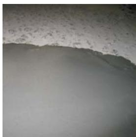
**Morfluis** est un mortier fluide sans rétraction spécial pour les chapes autonivellantes de jusqu'à 30mm d'épaisseur.
