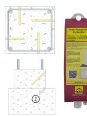
1. Perforation à réaliser en cas de saturation importante d'humidité
