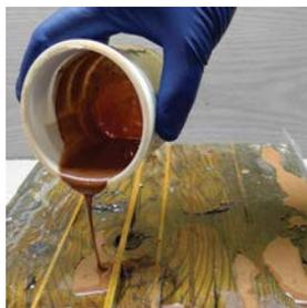
**Madepois Líquido**, est un produit formulé comme pâte de remplissage et adhésif de grand pouvoir à base de résines époxy, farine de bois et libre de dissolvants, qui se mélangent au moment de son utilisation, permet de réaliser des réhabilitations et le collage de bois et bois ou autres matériaux comme le béton, la pierre, etc.
