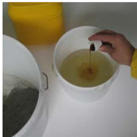
**Plais N** est un plastifiant pour mortiers et bétons, qui est idéal pour obtenir une excellente plasticité facilitant énormément sa manoeuvrabilité et améliorant la pose sur chantier.
