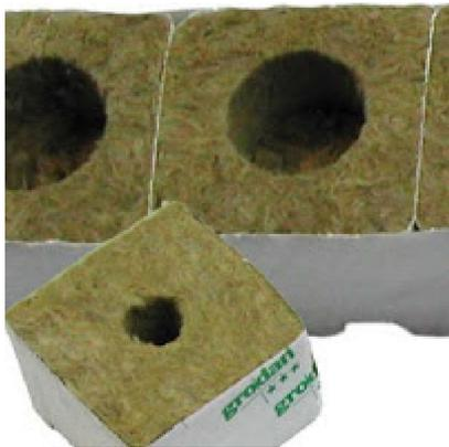
El sustrato, el sistema está pensado tanto como para un sustrato vegetal enriquecido, con una capa de grava de drenaje como para la realización de un cultivo hidropónico mediante lana de roca y riego enriquecido.
