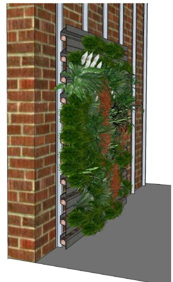
***Perfiles portantes verticales**, destinados a soportar los perfiles jardinera, así como a transportar el riego por su interior*
